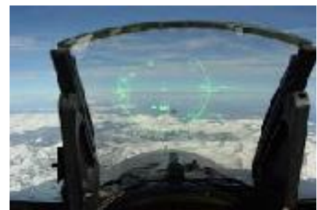
Gambar 2 : tampilan HUD pada pesawat F16
