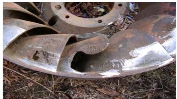
Gambar 5 Guide vane yang patah akibat hantaman kerikil.
