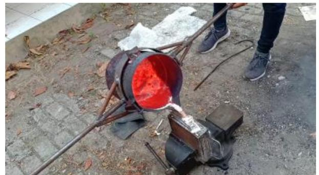
Gambar 2.6 Proses penuangan
