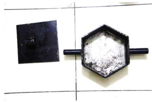
Gambar 4. Desain Mesin Pencetak Segmen Sloof Balok Moduler
