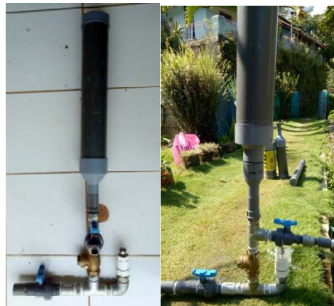
Gambar 4.2 Hasil Pembuatan Prototype Pompa Hidram
