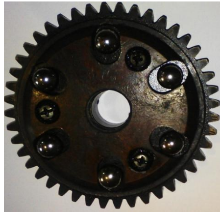
Gambar 4. Governor pada posisi tanpa beban
